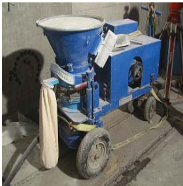
Figura 1. Pistola MEYCO® Piccola con filtro para captación de polvo
