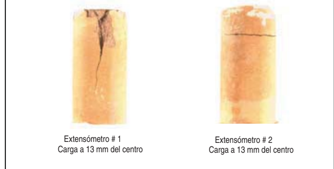
Figura 8 - Patrones de agrietamiento reales para los cilindros ensayados a compresión, colocados a 13 mm (1/2 in) del centro
