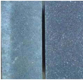
Figura 8. Dos bloques de concreto cortados longitudinalmente hechos con el mismo diseño de mezcla en lotes consecutivos. Se usó un aditivo tradicional repelente de agua/controlador de eflorescencia, en el bloque de la izquierda, que muestra eflorescencia; mientras que en el lado derecho, se utilizó una combinación polimérica patentada (RHEOPEL® XD), sin eflorescencia.
